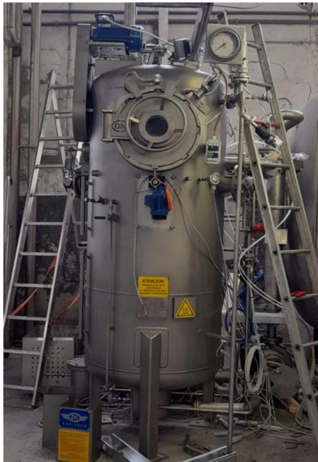
1- Máquina de tinte en cuerda con tecnología de micronebulización
