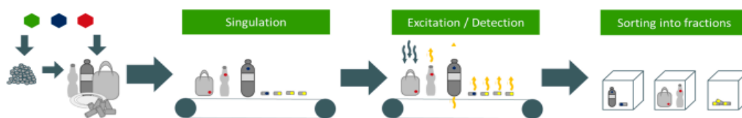
Figura 1: Principio de la clasificación por medio de marcadores para la identificación y la clasificación de los envases de plástico (extraído de ref. [3])
