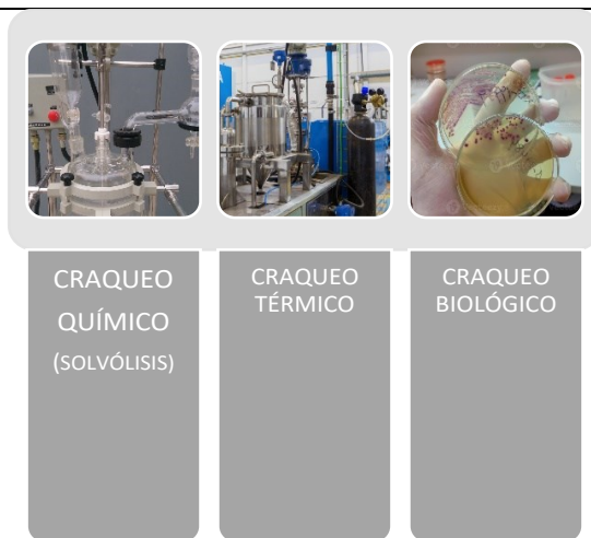
Figura 9. Procesos que engloba el reciclaje químico
