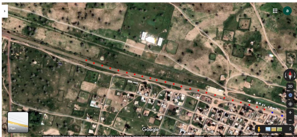
Replanteo de las farolas a lo largo de la carretera nacional 3
