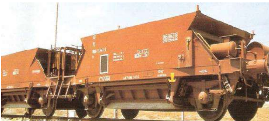
Ilustración 3: Vagones de transporte de balasto que se dotarían de ejes de ancho variable
