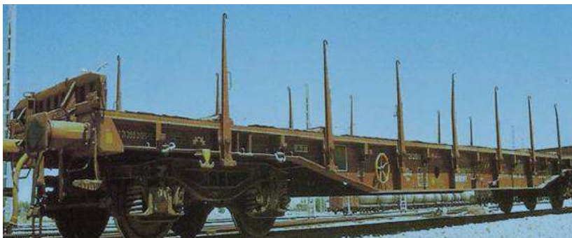
Ilustración 2; Vagón carrilero que se dotaría de ejes de ancho variable
