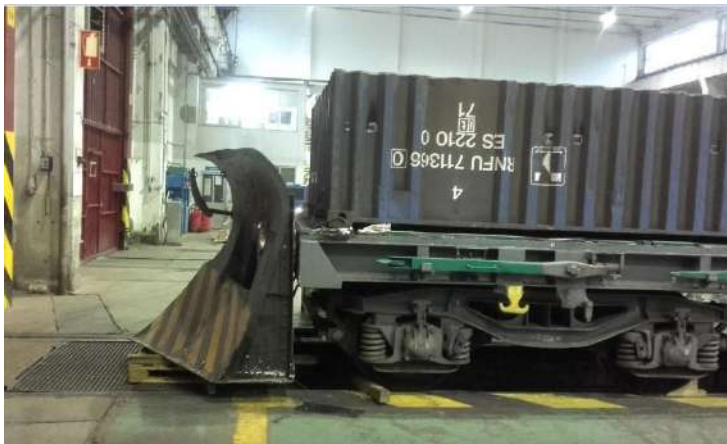
Ilustración 1. Vagón quitanieves que se dotaría de ejes de ancho variable
