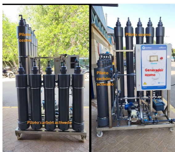
Ilustración 1. Planta piloto de ozono/carbón activado
